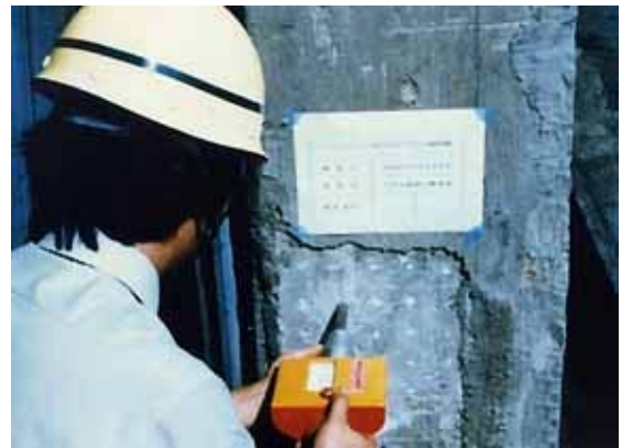
写真-1~2 シュミットハンマーによる圧縮強度の測定
