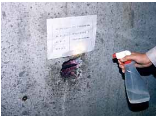
写真-8 フェノールフタレインの 1%エタノール溶液の塗
