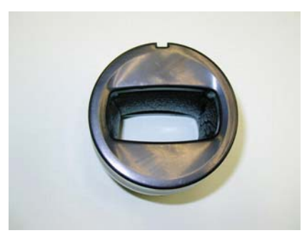
開放廊下を歩く音が気になり、給気口を閉めていた。音を小さくするため、給気口内に消音管を設置した。
